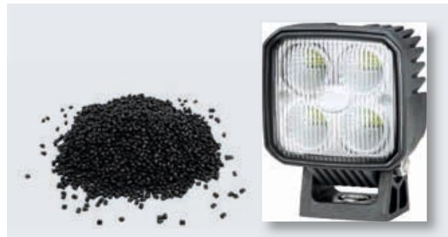
Materiais sintéticos especiais com capacidade de condução térmica que evacuam o calor para fora dos LEDs.
