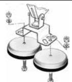
**Séries de modelo:** todos os faróis de trabalho com estribo padrão e fixação de quatro pontos
